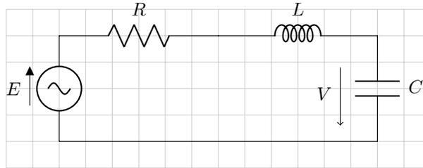
Le circuit est soumis à une tension  $E$  (en volts). On cherche à calculer la tension  $V$  (en volts) aux bornes du condensateur. On note  $I$  l'intensité (en ampères) du courant électrique dans le circuit. On rappelle que la fonction  $t \mapsto V(t)$  vérifie l'équation suivante
