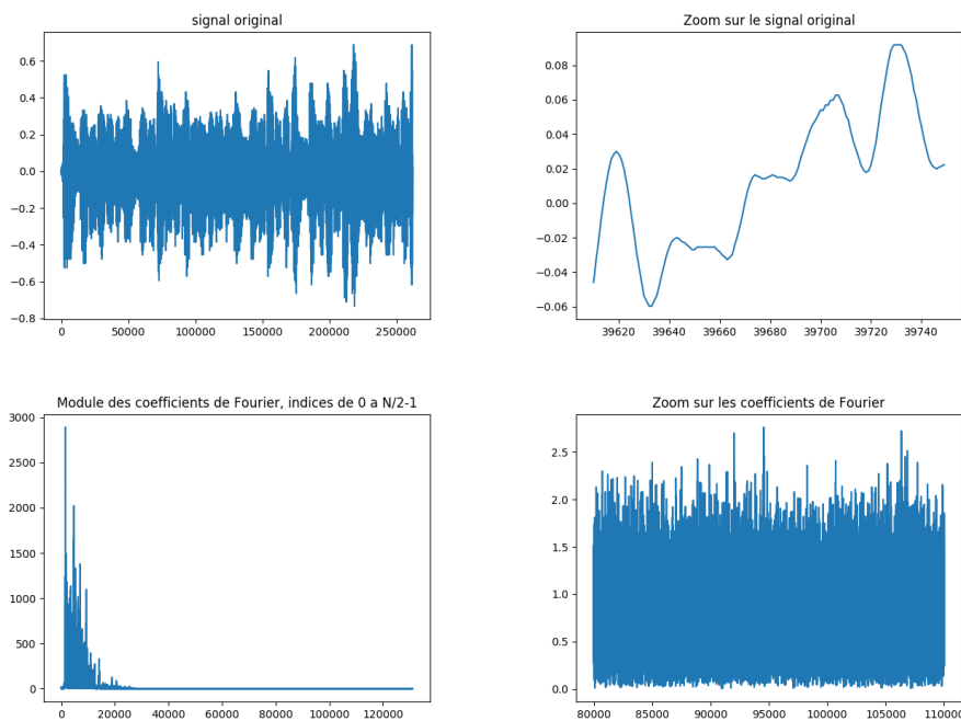
FIGURE 1 – Tracé du son u original et du module de ses coefficients de Fourier. On voit en particulier que le module des coefficients de Fourier |\hat{u}_k| pour k grand devient « petit » devant \max_k |\hat{u}_k| .
