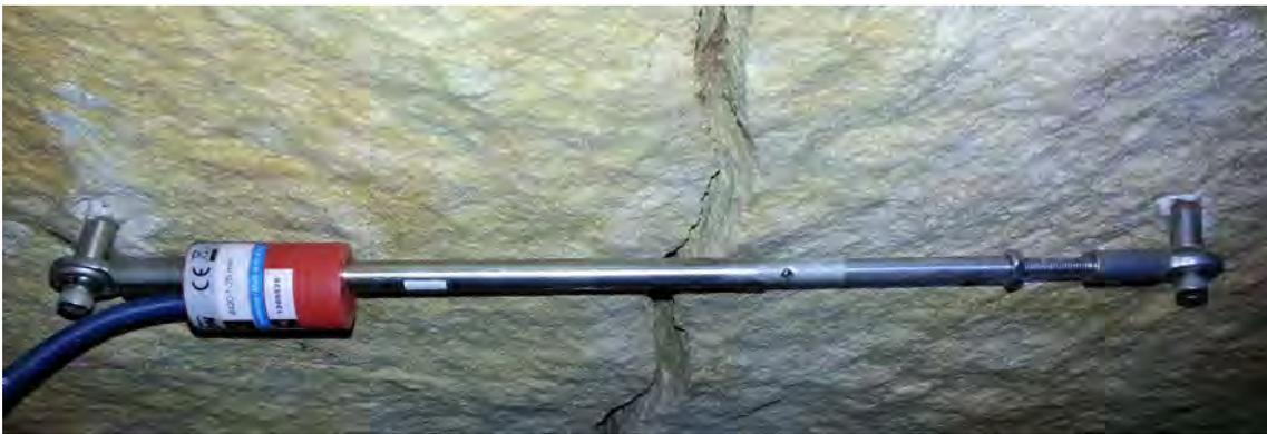
FIGURE 1 – Implantation d'un fissuromètre
