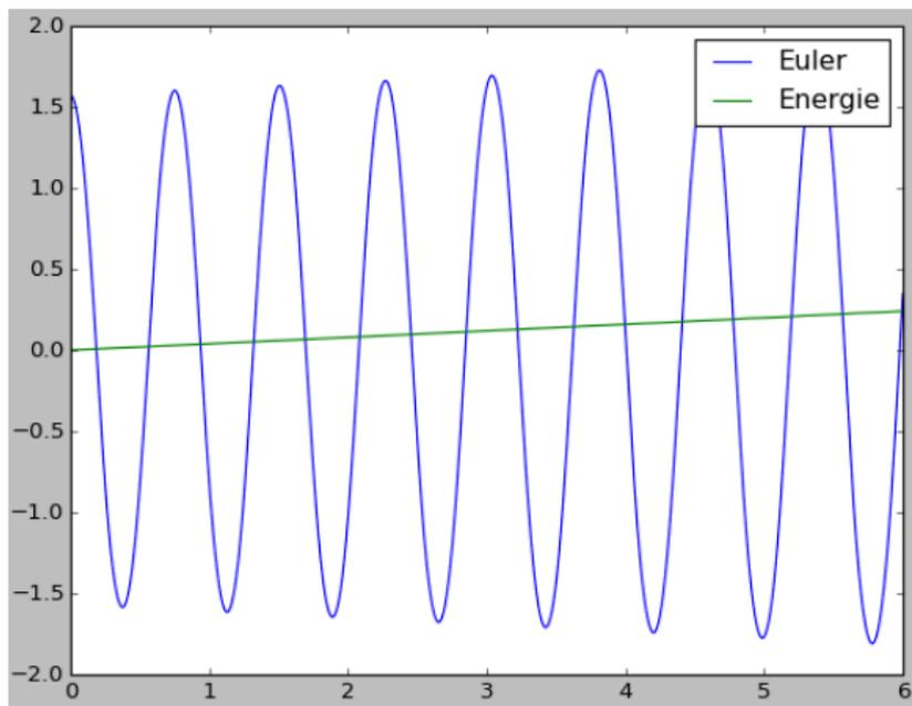
La résolution à l'aide de la méthode d'Euler donne un résultat insatisfaisant : avec 10000 points, l'énergie semble non conservative, et le mouvement va s'amplifiant !
