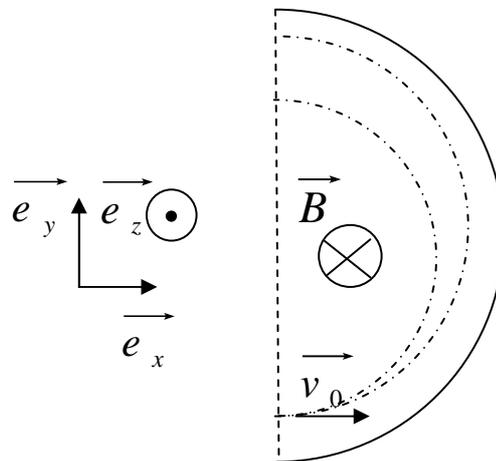
Schéma du spectromètre de masse
