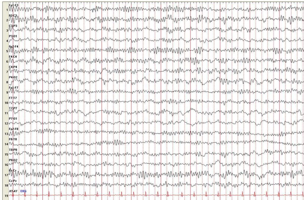
FIGURE 1.4 – Un exemple de signal EEG “multicapteur”. En abscisse le temps, en ordonnée les signaux mesurés sur un certain nombre de capteurs.
