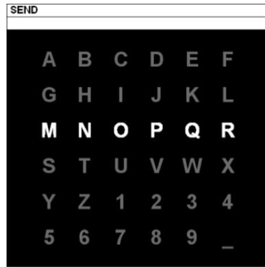
FIGURE 1.5 – Une matrice de caractères utilisée dans le dispositif *P300 speller*.
